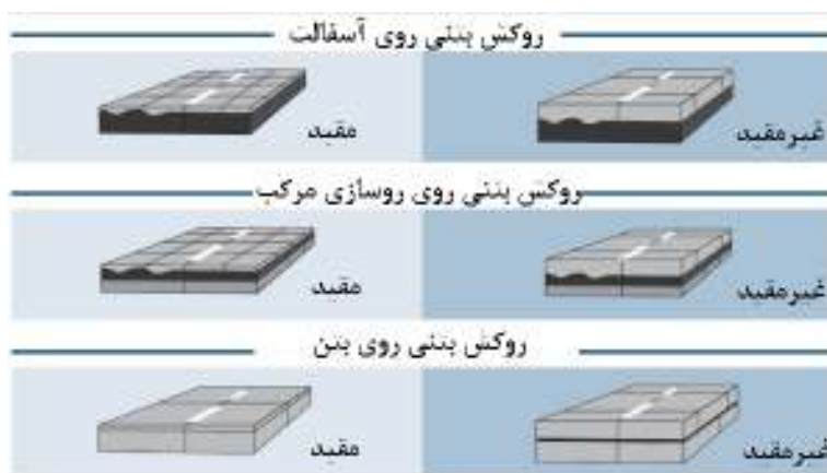
شکل ۱- شکل شماتیکی از نحوه‌ی ترمیم با روکش‌های بتنی مقید و غیرمقید [۱]
