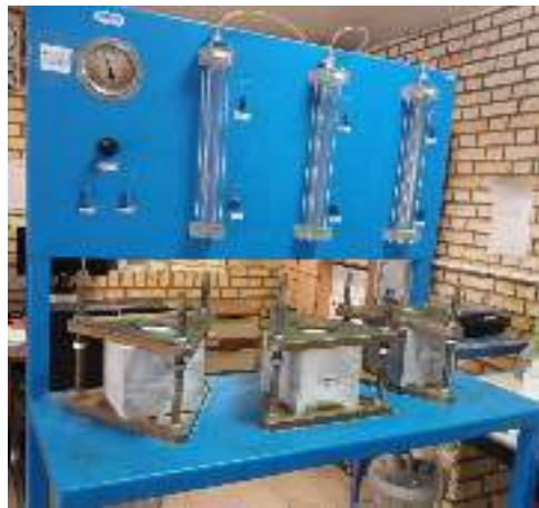
شکل ۵- دستگاه آزمایش عمق نفوذ آب تحت فشار
