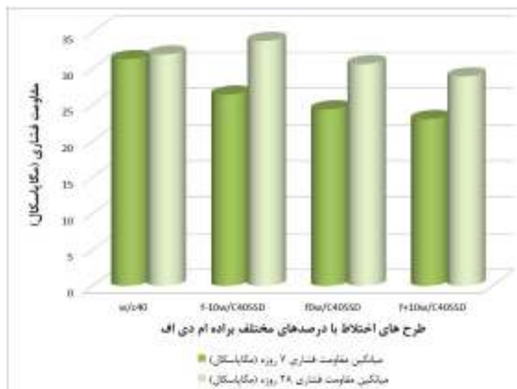
شکل ۳- مقاومت فشاری طرح های با نسبت آب به سیمان ۰/۴ و استفاده از فیبر اشباع
