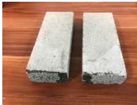
شکل ۹- آزمایش کشش ناشی از خمش (تعیین مدول گسیختگی)
