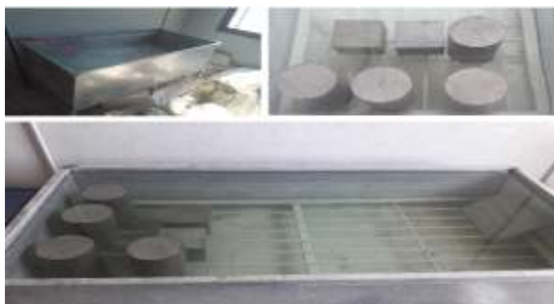
شکل ۴- قرارگیری نمونه‌ها در حوضچه آب
