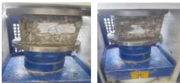
شکل ۶- نحوه گسیختگی نمونه‌ها
