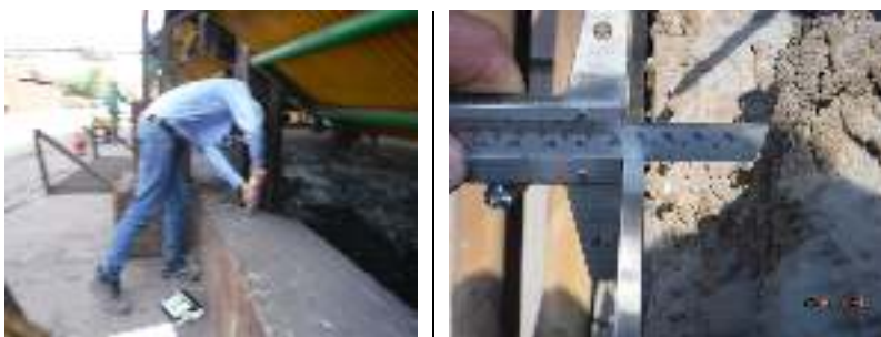
شکل ۵ - اندازه گیری ابعاد هندسی ناحیه خورده شده
