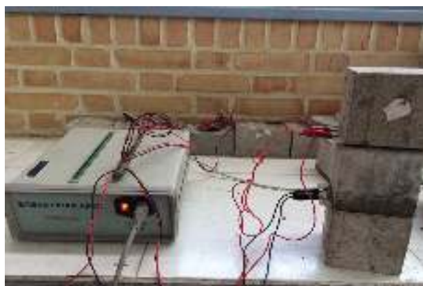
شکل ۲ چگونگی برقراری مدار اندازه گیری مقاومت الکتریکی
