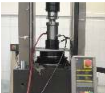
شکل ۷- نمونه‌ها تحت بارگذاری فشاری سه محوری دستگاه MTS
