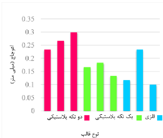
شکل ۹- میانگین حداکثر اعوجاج نمونه‌های ۷ روزه با عیار 400 \text{ kg/m}^3
