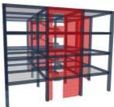
شکل (۲۱): خرابی دیوار برشی در محل بازشو
