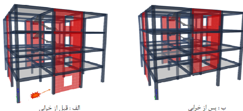
شکل (۸): مدل خرابی دیوار برشی طبقه اول به همراه ستون کناریش
