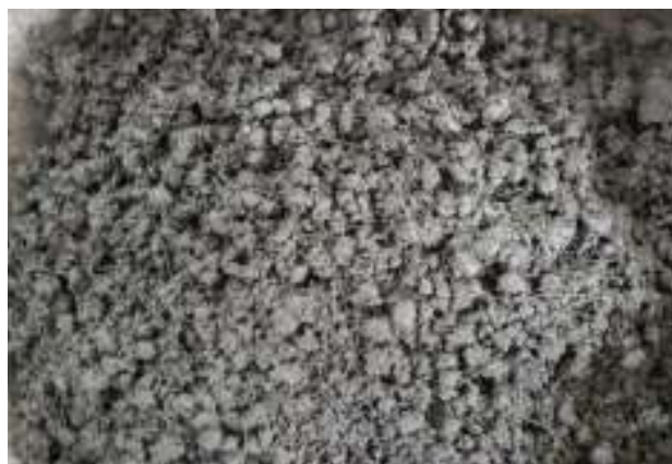
شکل ۹- نمونه‌ای از اختلاط کامل کلیه مصالح با یکدیگر
