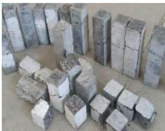
شکل ۱۱- شکست تعدادی از نمونه‌های منشوری بتن سبک تحت کشش مستقیم
