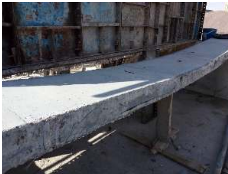
شکل ۴- تغییر شکل اولیه دال بتنی با ۱ لایه ورق GFRP
