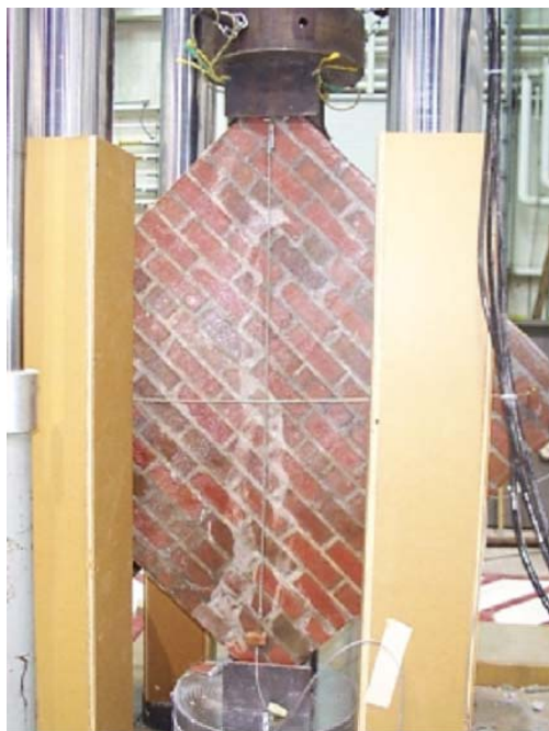
شکل ت-۲-۷ آزمایش فشاری قطری
