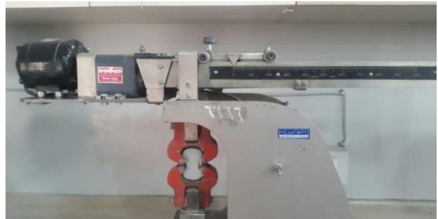
شکل ۴- آزمایش تعیین مقاومت کششی
