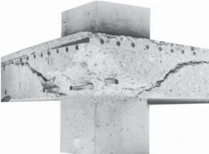
مشکل پانچ (برش منگنه ای) در دالهای تخت (بدون تیر و بدون سرستون)
