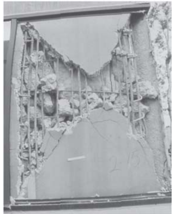
در شکل فوق به دلیل پر فولاد بودن دیوار، میلگردها تسلیم نشده اند.
