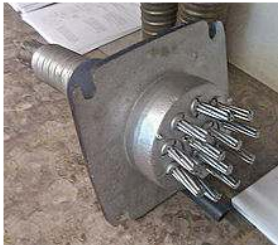
شکل ۲- لنگرگاه کابل چند رشته‌ای [۵]
