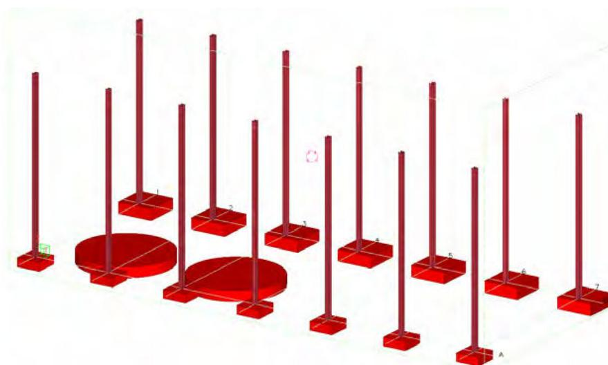
ما اکنون قصد داریم سیلوها را با استفاده از پروفایل پارامتری ایجاد کنیم برای این منظور باید یک جایگزین دقیق جهت ایجاد یک استوانه توخالی با یک ورق که سر آن جوش داده می شود :
