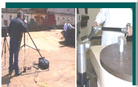
سیستم اندازه گیری دستی شامل توتال استیشن(چپ) - ماشین اندازه گیری مختصات(راست)
