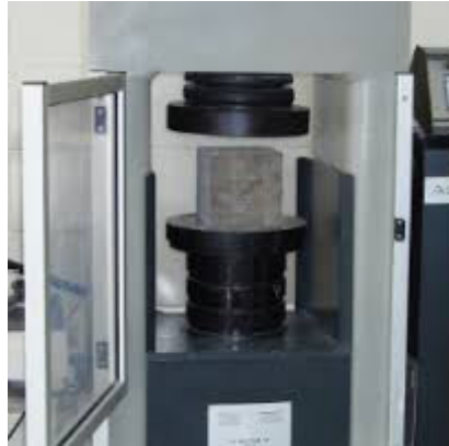
شکل ۱- آزمایش مقاومت فشاری
