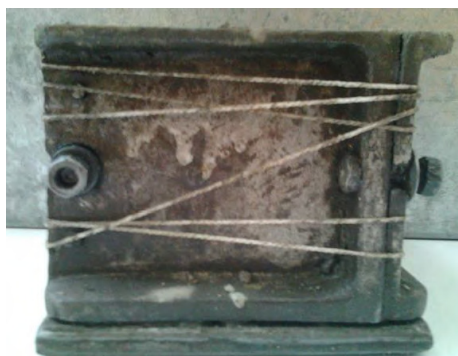
شکل ۳- دور پیچ کردن قالب ها با ریسمان
