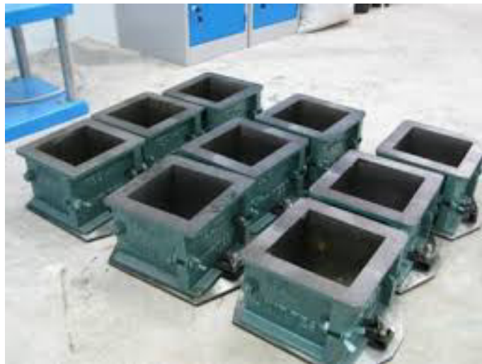
شکل ۲- قالب نمونه های مکعبی تهیه شده
