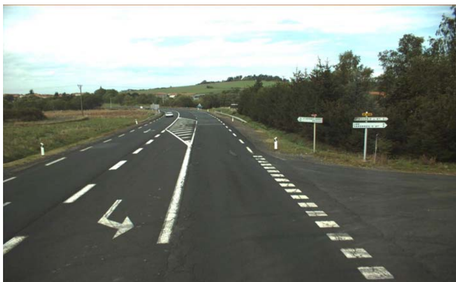
تصویر ۲- نمونه ای از نحوه ایجاد ناحیه ایمن برای حرکت گردش به چپ در محل دسترسی
