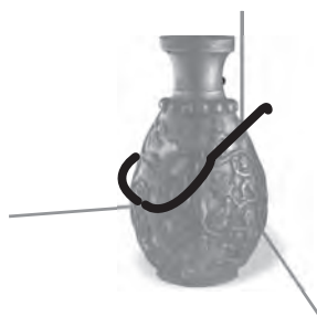
استفاده از سیم خم شده برای محافظت از ظرف؛ برای آثار هنری لغاف نرمی به دور سیم اضافه شود
