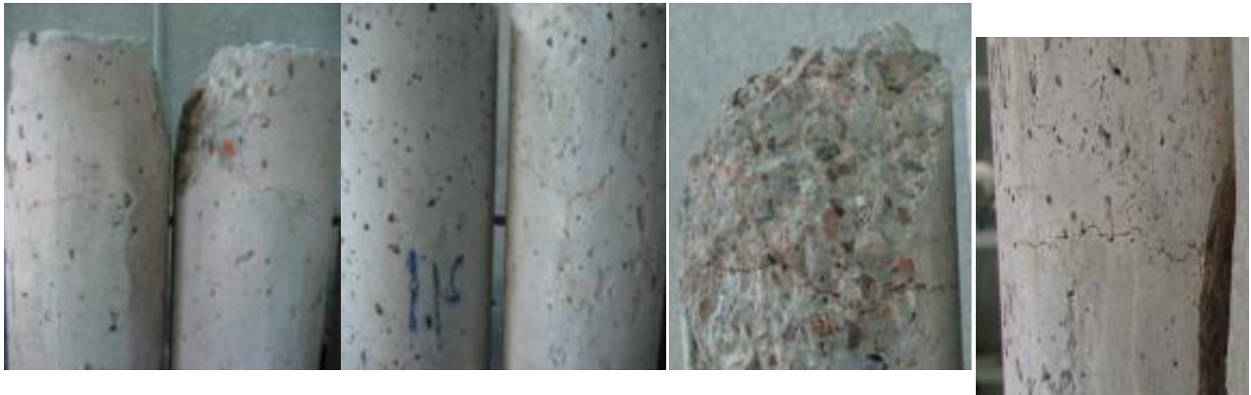
ترک‌های محیطی ایجاد شده در لایه‌های یک سوم بالا و پایین
