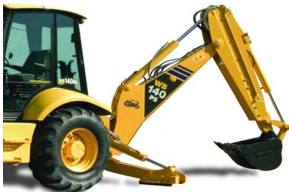
شکل شماره ۲-۹-۱۱- پایه‌های تعادل کننده دستگاه بک‌هو لودر در هنگام کار بیل
