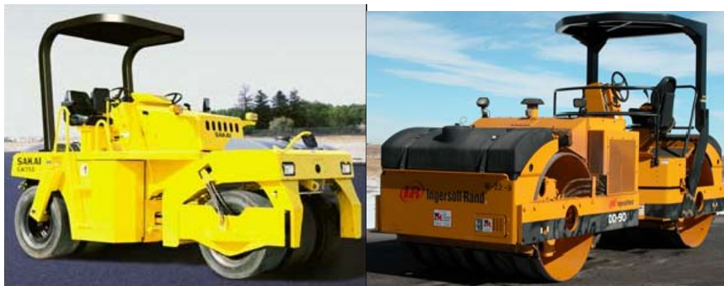
شکل ۲-۴-۶ و ۲-۴-۷- غلتک چرخ لاستیکی ارتعاشی (سمت چپ) و غلتک چرخ آهنی صاف ارتعاشی (سمت راست)
