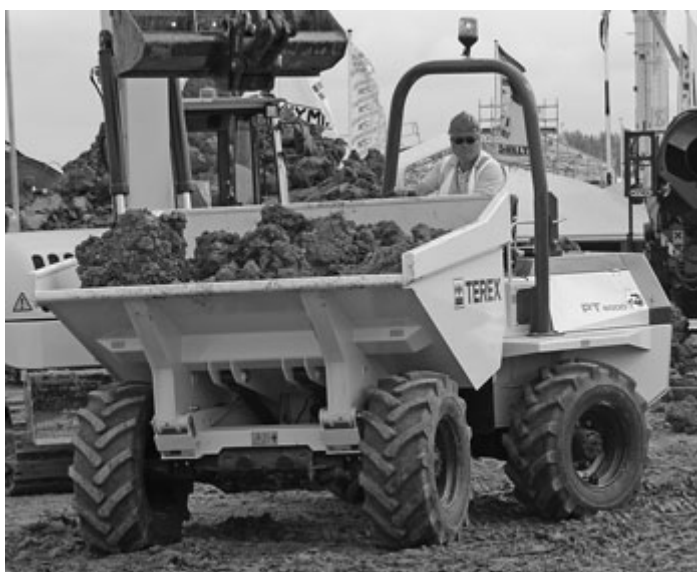
شکل ۲-۱۱-۲- دامپر با ظرفیت ۷ تن از نوع تخلیه از جلو
