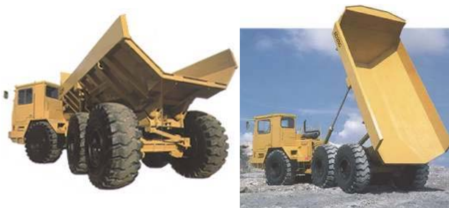
شکل ۲-۷-۵- کامیون کمرشکن در حال تخلیه
