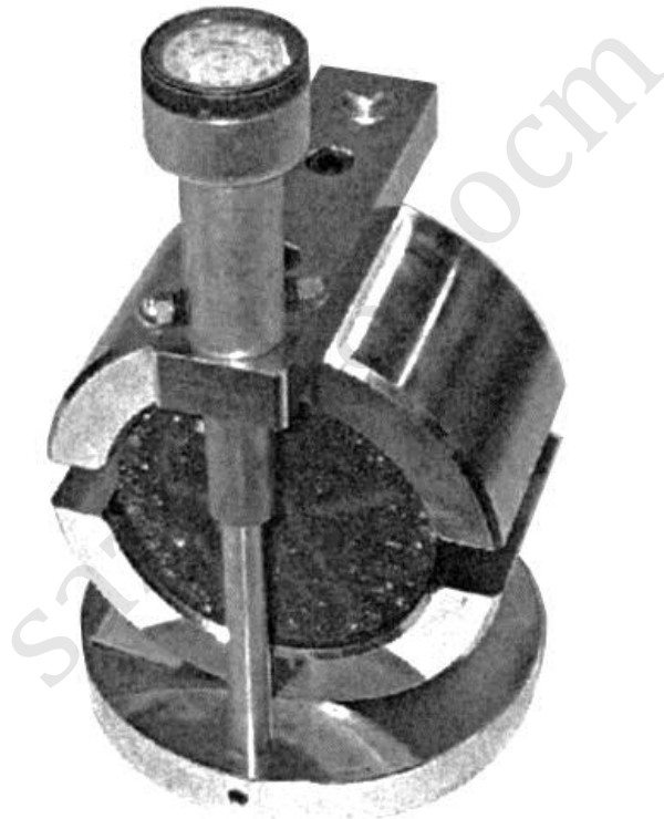
شکل ۴- نمونه‌ای از روانی‌سنج (استفاده شده در روش آزمون الف)
