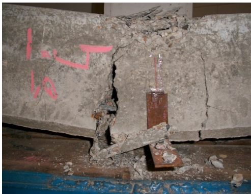
شکل ۷- نحوه آزمایش تیر کششی و شکست تیر و گسیختگی فولاد کششی
