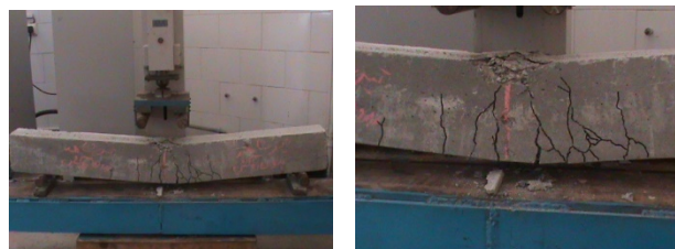
شکل ۵- نحوه شکست تیر شاهد
