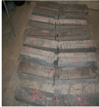
شکل ۸- تیر خمشی مسلح روکش شده با الیاف فلزی
