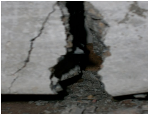
شکل ۶- نحوه آزمایش تیر فشاری و شکست تیر
