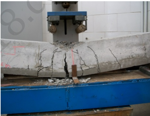
شکل ۶- نحوه آزمایش تیر فشاری و شکست تیر
