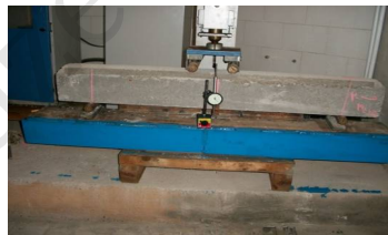
شکل ۴- نحوه بارگذاری آزمایش تیر خمشی مسلح
