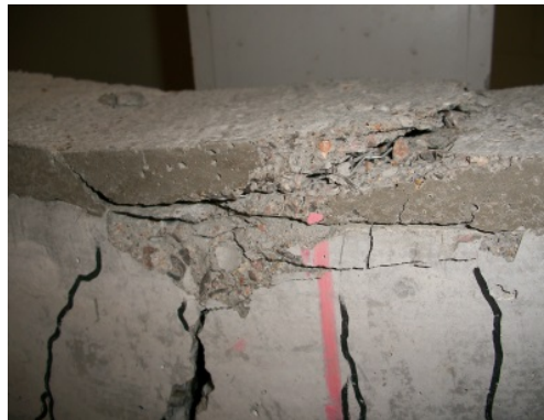
شکل ۶- نحوه آزمایش تیر فشاری و شکست تیر
