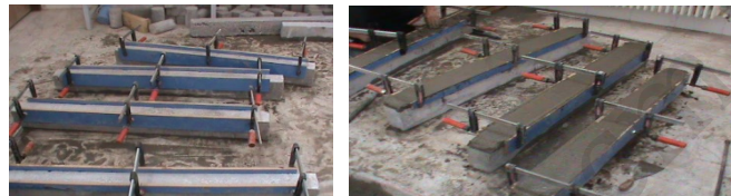
شکل ۳- نحوه مقاوم‌سازی تیر مسلح با روکش
