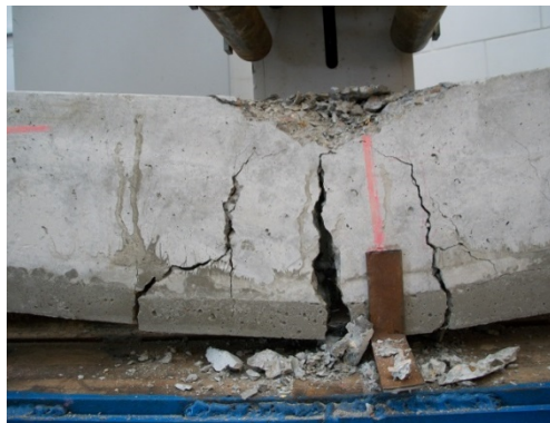
شکل ۷- نحوه آزمایش تیر کششی و شکست تیر و گسیختگی فولاد کششی
