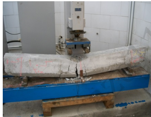
شکل ۶- نحوه آزمایش تیر فشاری و شکست تیر
